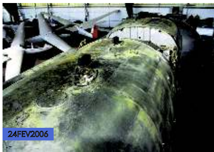
Aspecto superior da fuselagem, uma das áreas que mais necessitaram de recuperação
