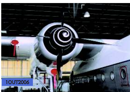
Imagem do motor Bristol Hercules já com o spinner montado e a característica pintura em espiral. Notar o hélice em bandeira
