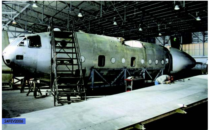
Tratamento de corrosão. Um técnico em trabalhos de recuperação de uma asa do avião, separada do corpo central
