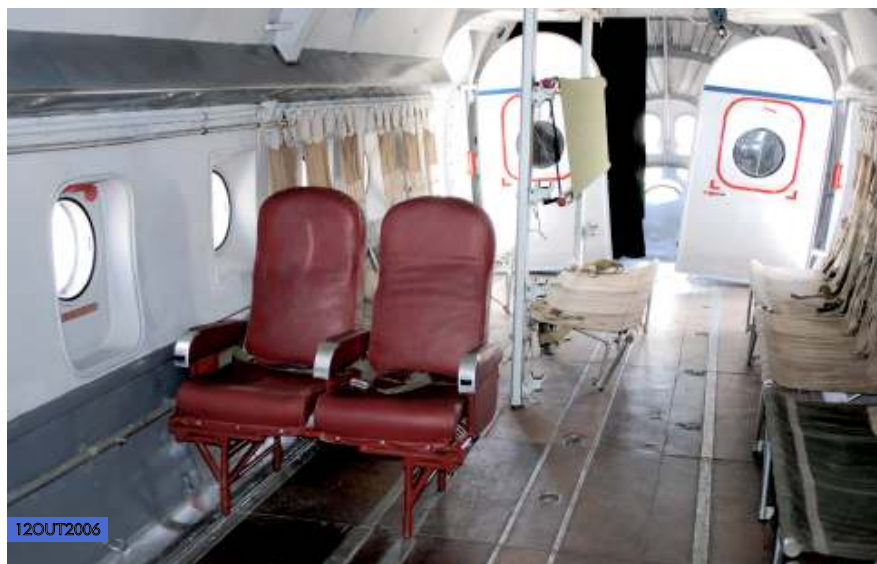
Na configuração pós-restauro, pode admirar-se a qualidade do trabalho da cabina, na qual foram incluídos assentos VIP e a instalação de uma maca, demonstrando assim a polivalência da aeronave
