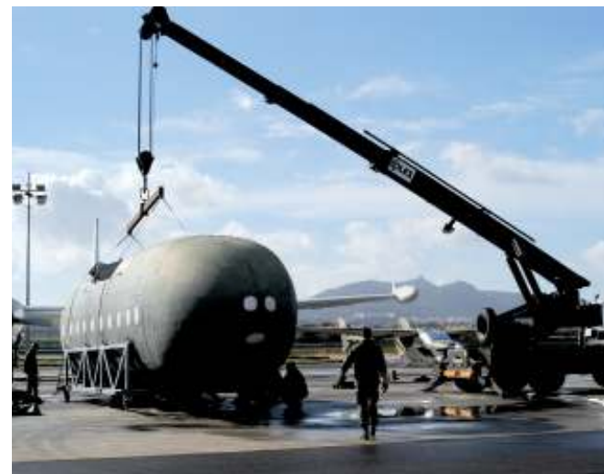
Pormenor da operação e colocação do corpo central do Noratlas na estrutura metálica
